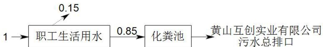
图 2-2 项目水平衡图（单位：t/d）
